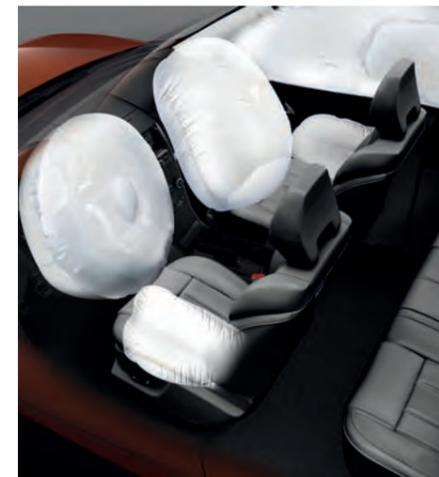
**AIRBAG** - La sicurezza passiva è completa ed efficace, con 6 airbag: uno per guidatore e passeggero, due laterali e due a tendina (versioni W8-W10).
