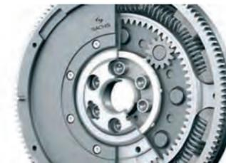
**VOLANO BIMASSA** - Riduce le vibrazioni e rende più scorrevole la marcia, aumentando anche la fluidità del cambio. Una soluzione tecnica che rende il motore di XUV 500 tra i più sofisticati propulsori sul mercato.
