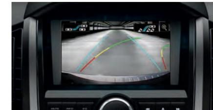
**TELECAMERA RETRO** - Anche i parcheggi in luoghi affollati o stretti non sono più un problema, con il sistema di assistenza con telecamera posteriore integrata di serie (W8-W10) e allerta audio che avvisa di ostacoli nel raggio di 1,20 metri.
